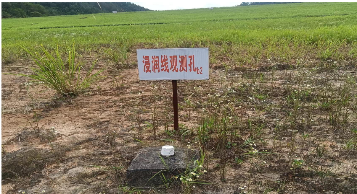
图 2-11 浸润线观测孔
